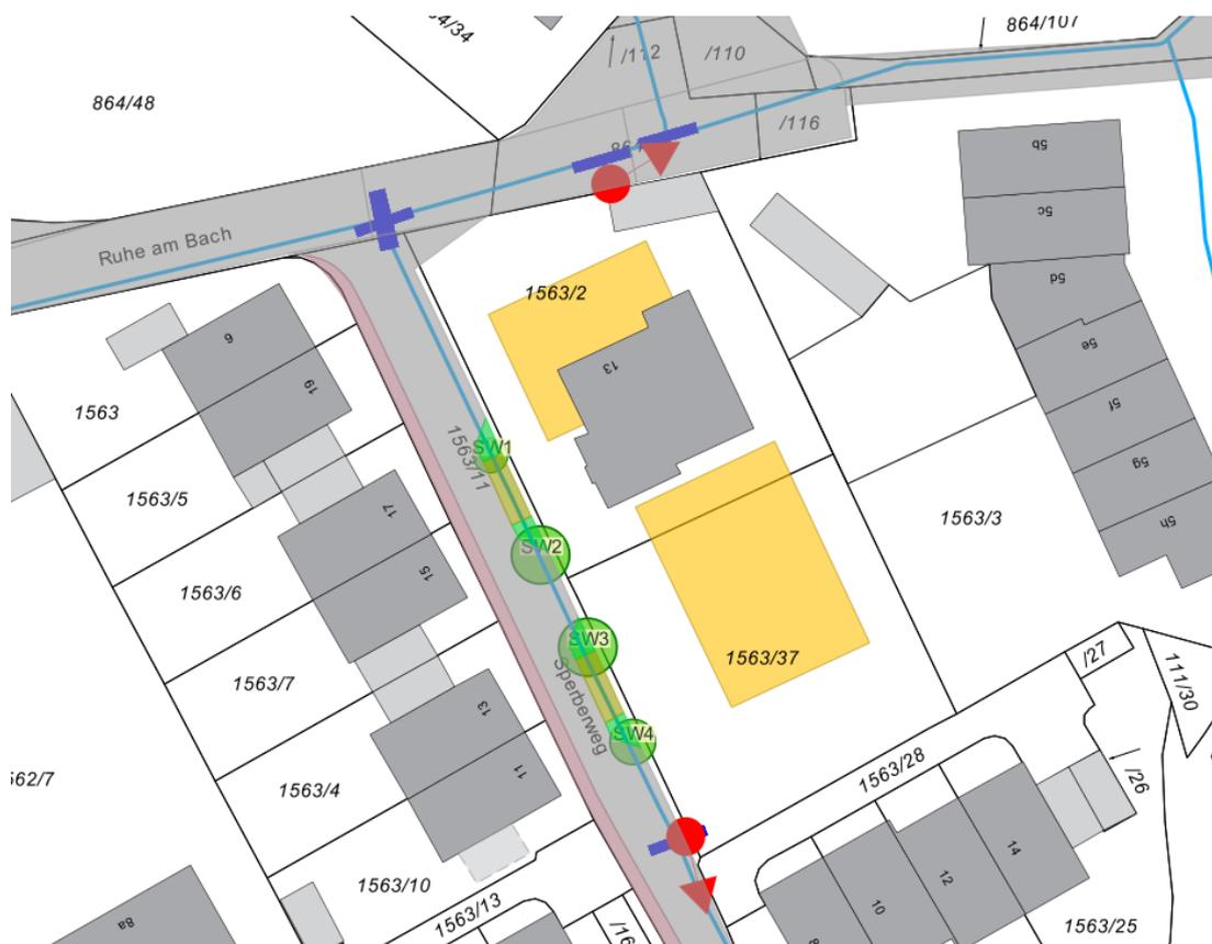
Die Hydranten sowie ein Stromverteiler liegen im Bereich der geplanten Einfahrten. Diese müssen auf Kosten vom Antragsteller noch Rücksprache mit den jeweiligen Spartenträger versetzt werden.
